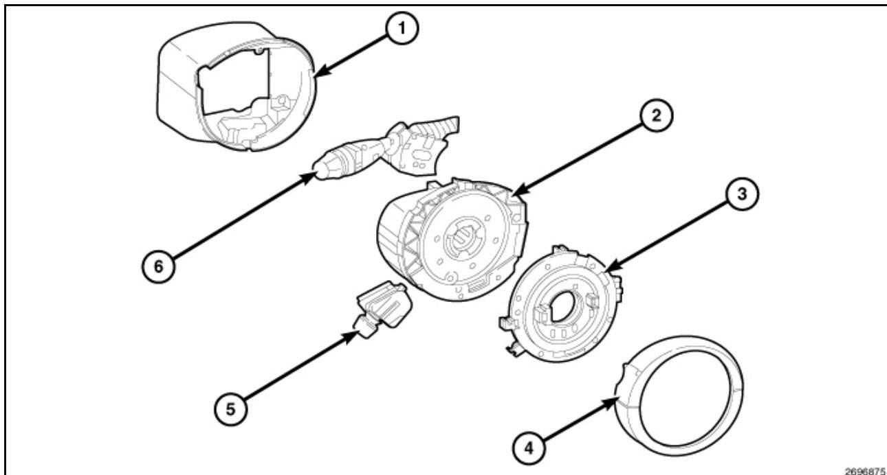
瞬时转向状况下横向加速传感器无法测量汽车的实际摆动力。欲弥补此缺失, 系统会使用转向角传感器(SAS) (2)与车辆速度估测实际摆动力。此信号与横向加速传感器信号相匹配, 可大幅降低车体的瞬时摆动力。SAS为转向控制模块(SCM)的一部分, 并且无法与SCM分开单独维修。有关SCM的更多信息([参见08 - 电气/电子控制模块/转向柱模块- 说明](#))。有关SAS (SCM)的更换步骤([参见08 - 电气/电子控制模块/转向柱模块 - 拆卸](#))。
